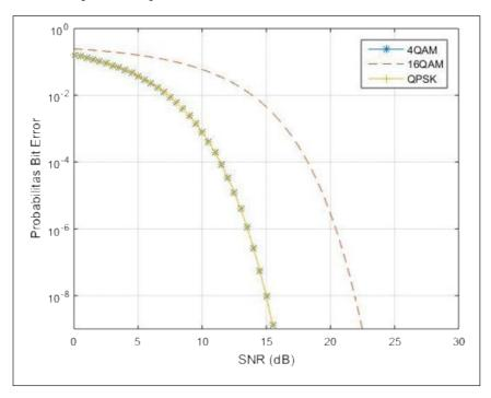
Gambar 3. Grafik probabilitas error modulasi PSK dan QAM
