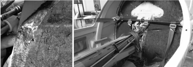
**Gambar 6.** Inspeksi *fuselage* bagian *wall cover*, yang sudah mengelupas (kiri) dan sudah dilepas (kanan)
