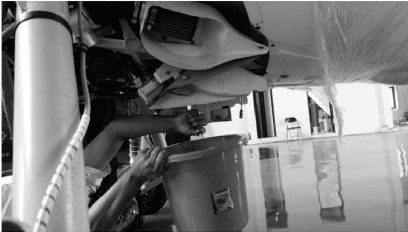
**Gambar 11.** Drain Oli Hidraulik sebelum pemasangan selang yang baru
