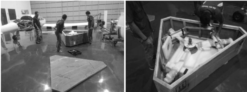
**Gambar 16.** Pemeriksaan kondisi komponen *propeller* setelah melalui perjalanan dari pabrik di Jerman
