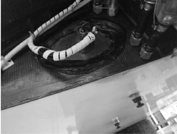
**Gambar 5.** Inspeksi *fuel tank* (kondisi terakhir sudah tidak bocor)
