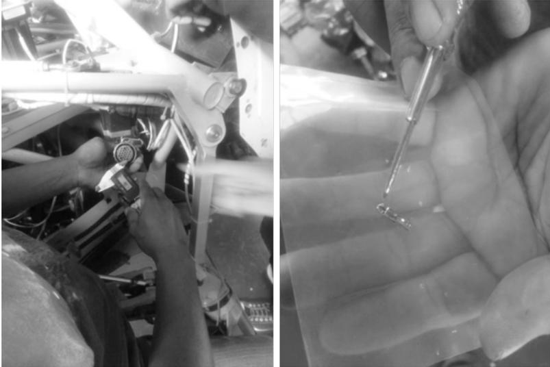
**Gambar 15.** *Troubleshooting* koneksi kabel dan pin kabel yang rusak
