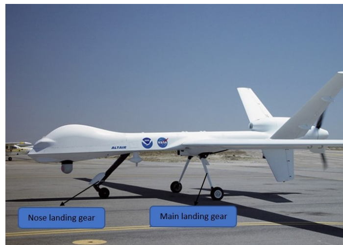
Gambar 1 Landing gear jenis tricycle landing gear pada pesawat UAV [10]
