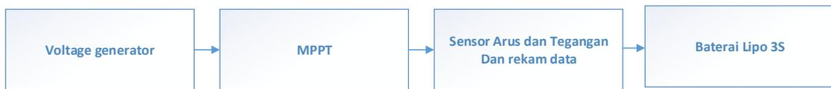
Gambar 3. Ilustrasi Sistem pengukuran kinerja modul MPPT
