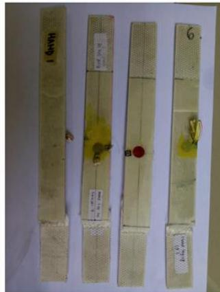
**Gambar 6. Hasil Penampakan Visual Hasil Uji Tarik Spesimen Komposit WR 185/Lycal**
