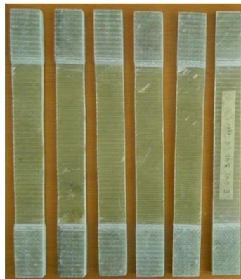
Gambar 3. Spesimen komposit WR 185/Lycal metode *Hand layup*
