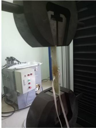
Gambar 4. Spesimen Komposit WR 185/Lycal saat dilakukan Uji Tarik.
