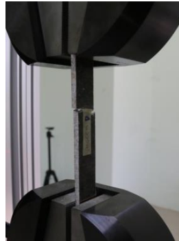
Gambar 6. Spesimen Telah Mengalami Kegagalan
