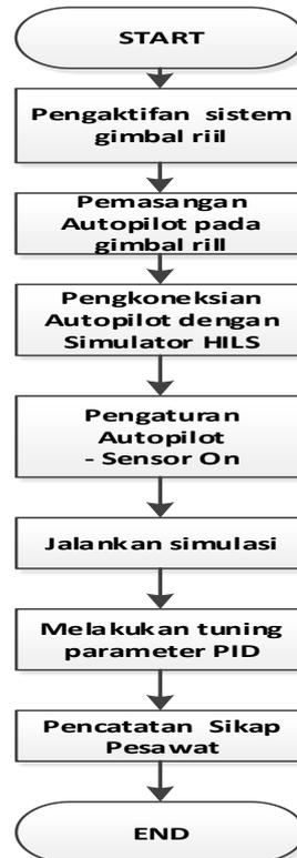
Gambar 7. Diagram alur metode simulasi pengendali sikap LSU 02 pada HILS dengan gimbal riil
