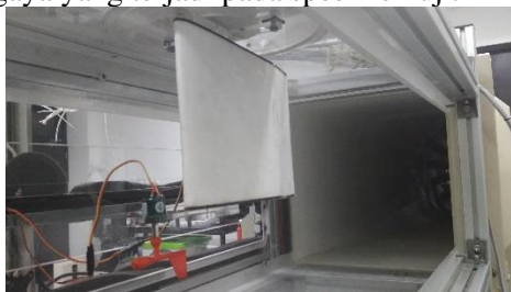
Gambar 3.2. Pemasangan potongan wing pada sensor gaya
