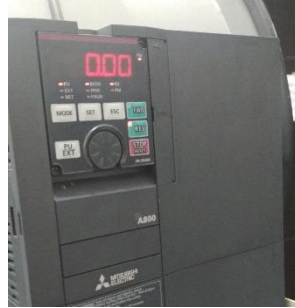
Gambar 3.3. Inverter fan wind tunnel
