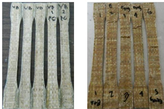
Gambar 5. Spesimen Uji Tarik
