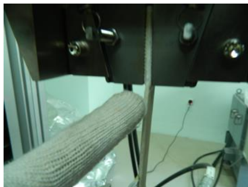
Gambar 6. Spesimen uji tarik telah mengalami kegagalan
