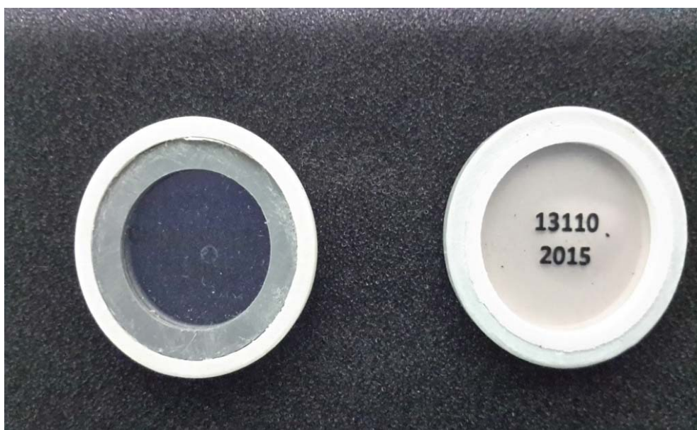
Gambar 5. Standar sekunder radioisotop ^{137}\text{Cs} dalam sumber tertutup shield sources dengan aktivitas 10330 \pm 411 \text{ Bq}
