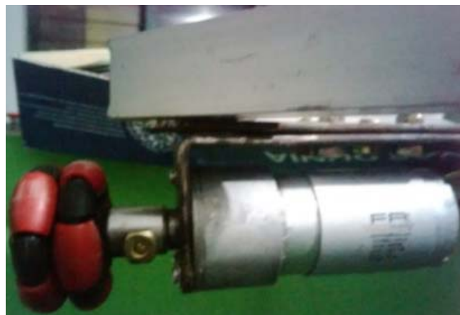
Gambar 7. Mekanisme omniwheel pada motor
