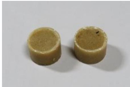
Gambar 1. Hasil imobilisasi limbah dengan matriks polimer resin epoksi
