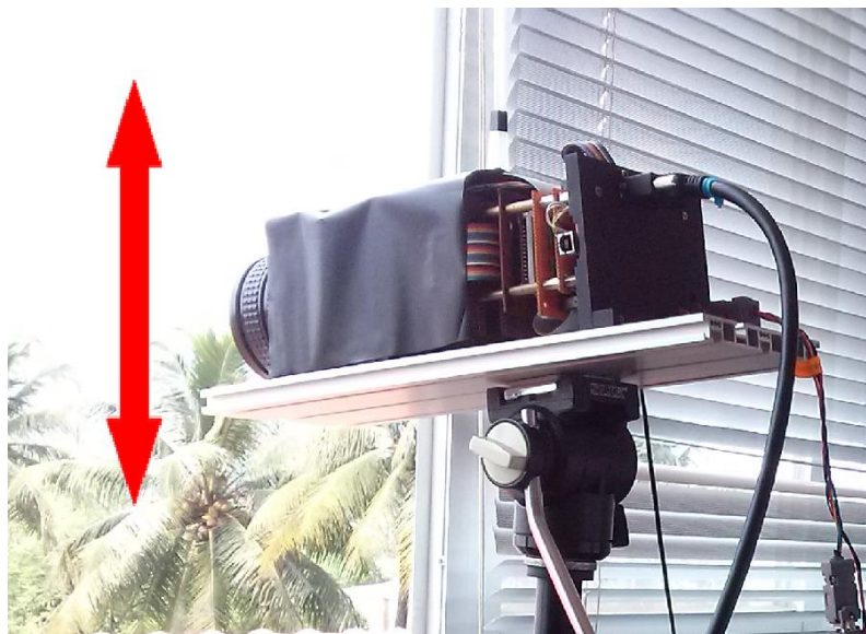
Gambar 8. Pengujian Camera Linier 3 kanal dengan menggunakan tripod dengan arah scanning atas bawah dengan pergerakan manual.
