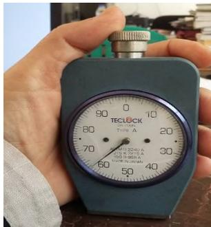
Gambar 3-3. Alat pengukur kekerasan
