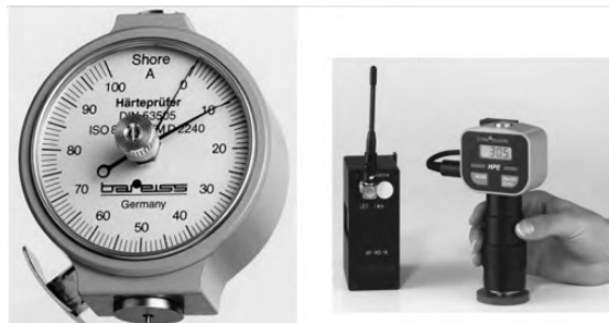
Gambar 1-3. Kiri : Durometer Analog, Kanan : Durometer Digital[13]
