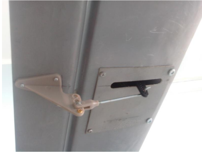
Gambar 3-1 Posisi hubungan servo pada horizontal tail dengan control horn untuk menggerakkan elevator
