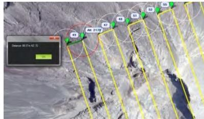
Gambar 9. Jalur lintasan LSU-01 untuk sidelape 74%
