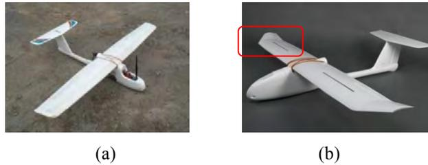
Gambar 3. LSU-01 wingspan 1600mm (a) dan LSU-01 wingspan 1900mm dengan wing tip
