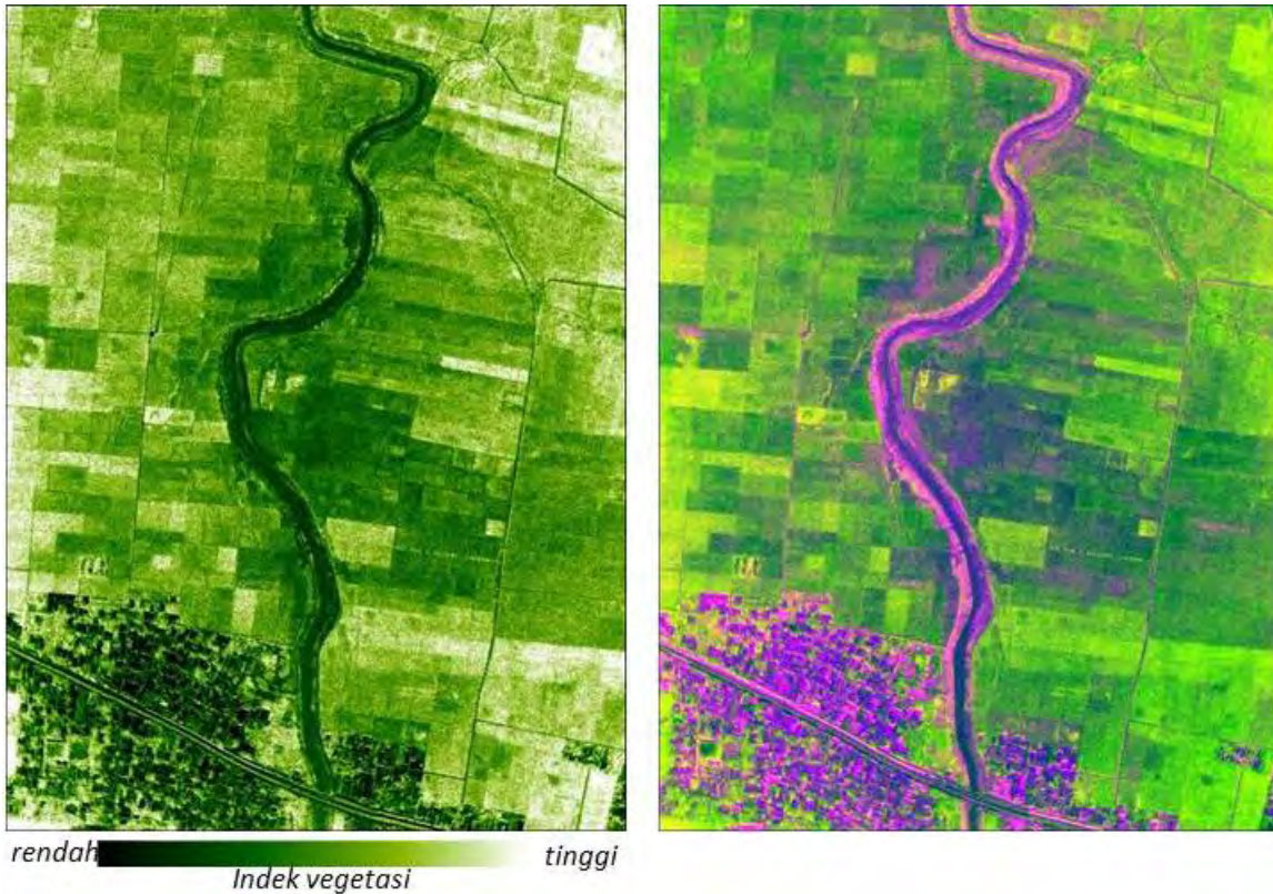
Gambar 9. Contoh untuk aplikasi pemantauan kondisi sawah, hasil transformasi NDVI dari data LSA (kiri) dan tampilan komposit warna R=band hijau, G=NDVI, B=band merah(kanan)
