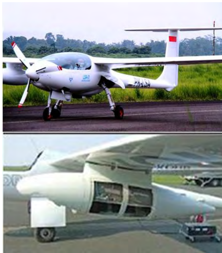
Gambar 2. Bentuk LSA dan mounting tempat kamera pada sayap kanan
