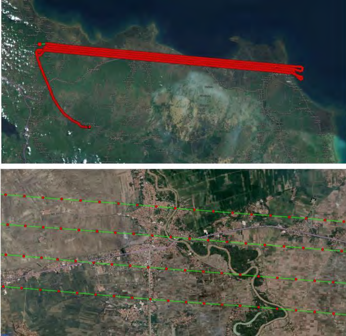
Gambar 7. Salah satu contoh posisi sensor saat akuisisi data dengan kamera pada LSA
