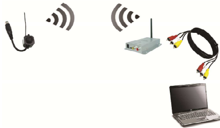
Gambar 2-9 Skema Koneksi Kamera Wireless ke Komputer
