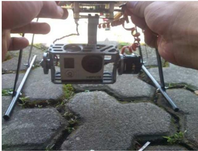
Gambar 4-1. *Payload Camera* pada Gimbal.
