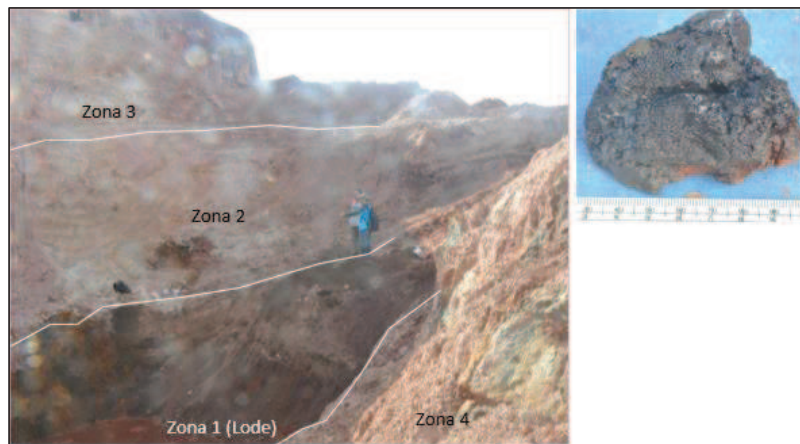
Gambar 5. Zona Lode Kasiterit-Magnetit±Sulfida Pada Batas Tubuh Batuan Granitik Dengan Meta Batupasir.
