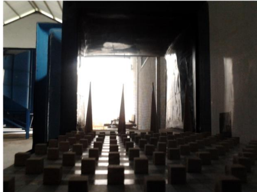
Gambar 4-7: Elemen kekasaran yang dipasang di Sand Erosion Wind Tunnel
