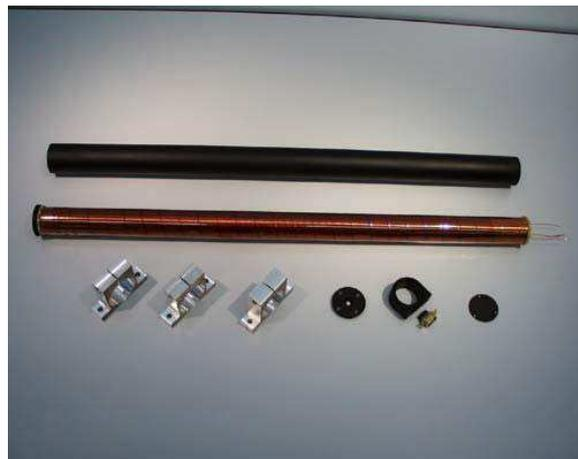
**Gambar 4.3.** Magnetic torque rod beserta alat mountingnya.
