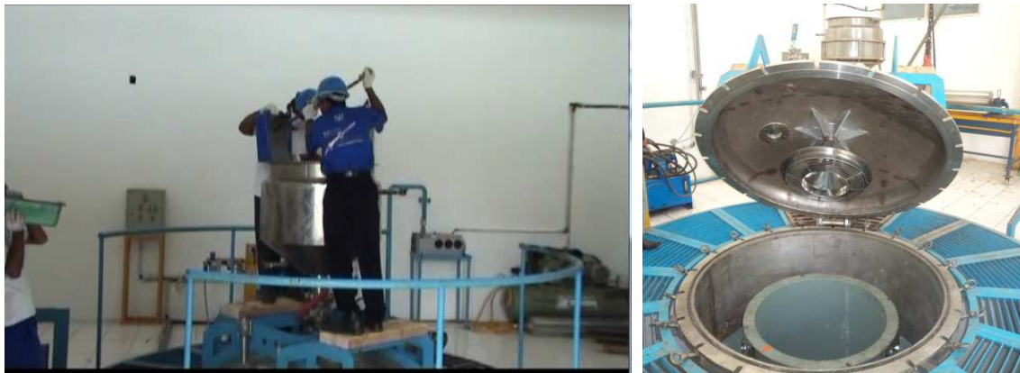
Gambar 4.1. Proses casting propelan D550 dan posisi slitter plate dalam casting chamber
