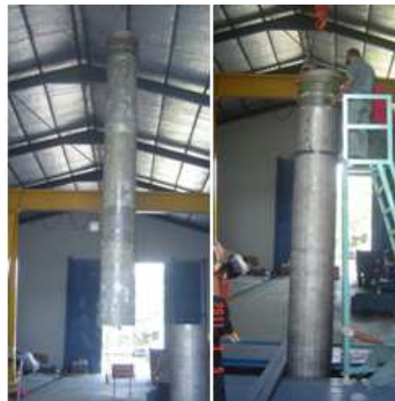
Gambar 1.3 Pemasukan propelan ke dalam tabung motor roket
