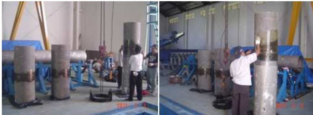
Gambar 1.2. Pelapisan propelan dengan protektor termal
