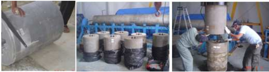
Gambar 1.1 Proses pemotongan dan penyambungan propelan
