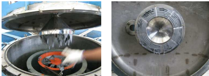
Gambar 4.4 Kondisi slitter plate setelah casting
