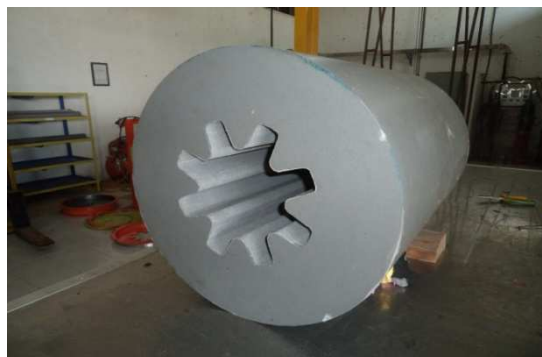
Gambar 4.5 Propelan D550 yang dihasilkan secara case bonded
