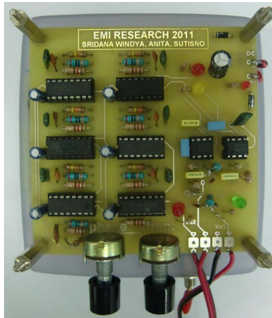
Gambar 11.1 : PCB rangkaian osilator.
