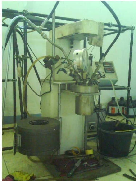
Gambar.2- 3. Rangkaian alat proses polimerisasi butadiene.
