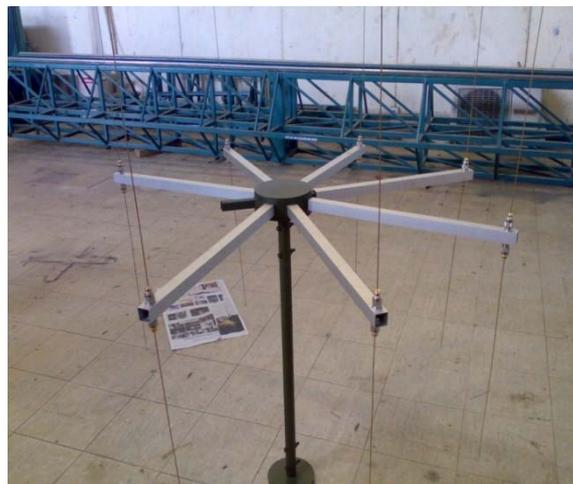
Gambar 2.2. Antena Doppler yang dikembangkan dengan 8 buah antena dipole melingkar.
