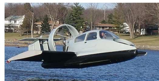
Gambar 1-3: Hoverwing konfigurasi katamaran dan skema transisinya (foto: se-technology.com)
