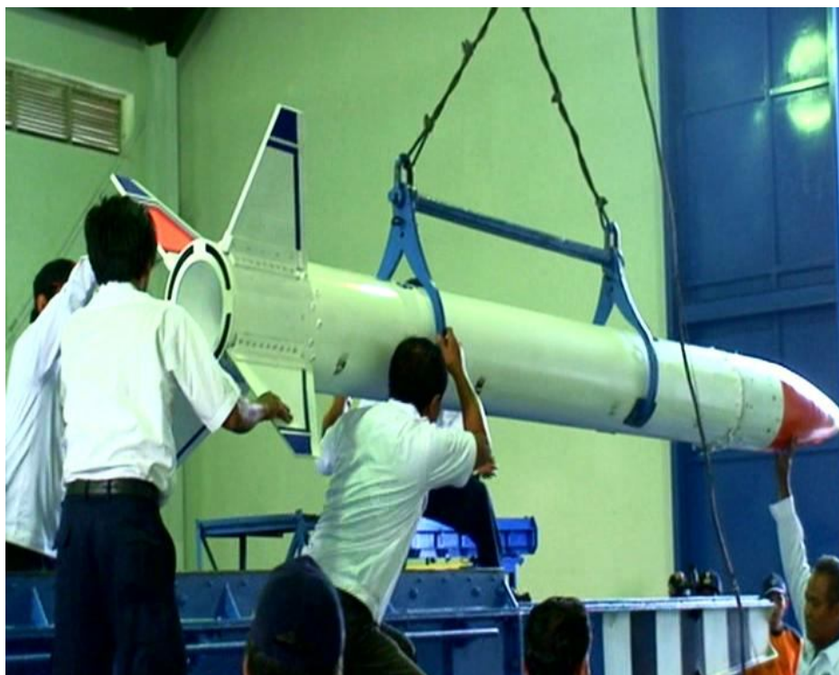
Gambar 1-1: Penempatan roket ke atas launcher
