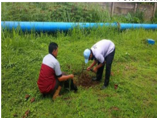
Gambar Pengambilan sampel tanah permukaan
