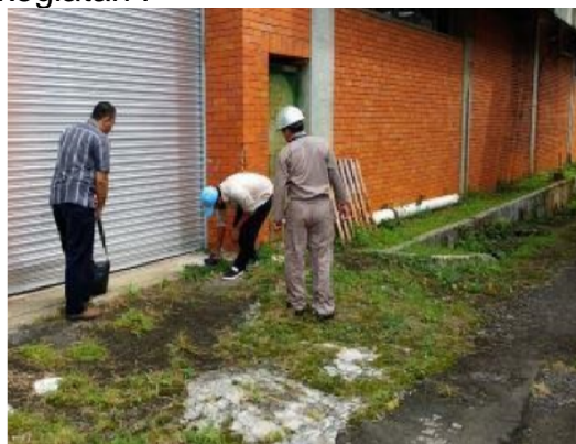
Gambar Pengukuran laju dosis radiasi udara ambien
