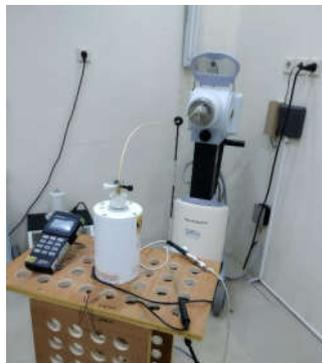
**Gambar 1.** Sumber radiasi HDR Ir-192 tipe Microselectron V2 dan detektor ionisasi *well type*
