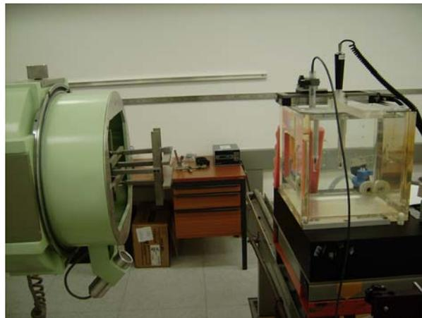
**Gambar 4.** Kalibrasi dosimeter dalam besaran dosis serap di air. Jarak sumber radiasi ke detektor 100 cm dengan lapangan radiasi pada bidang acuan 10 cm x 10 cm dan kedalaman detektor 5 cm
