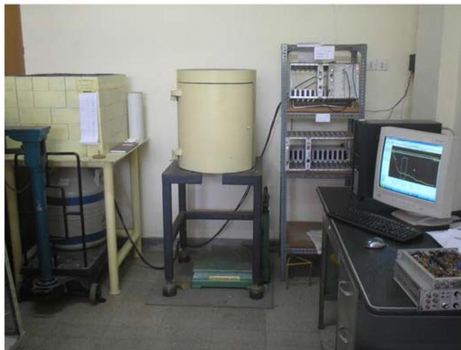
**Gambar 2.** Sistem Spektrometer Gamma Detektor HPGe GC1018
