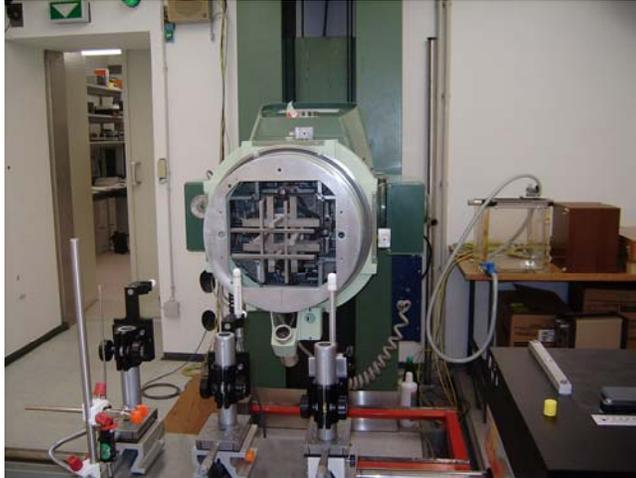
**Gambar 3.** Kalibrasi dosimeter dalam besaran kerma udara. Jarak sumber radiasi ke detektor 100 cm dan lapangan radiasi 10 cm x 10 cm
