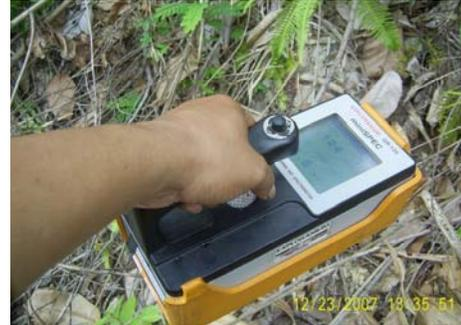
**Gambar 2.** Pengukuran laju dosis menggunakan EXPLORANIUM GR 130 portable<sup>7</sup>.
