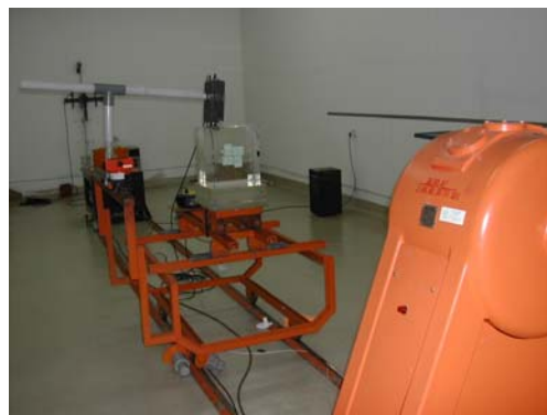
Gambar 3. Penyinaran dosimeter film dengan sumber 137 Cs
