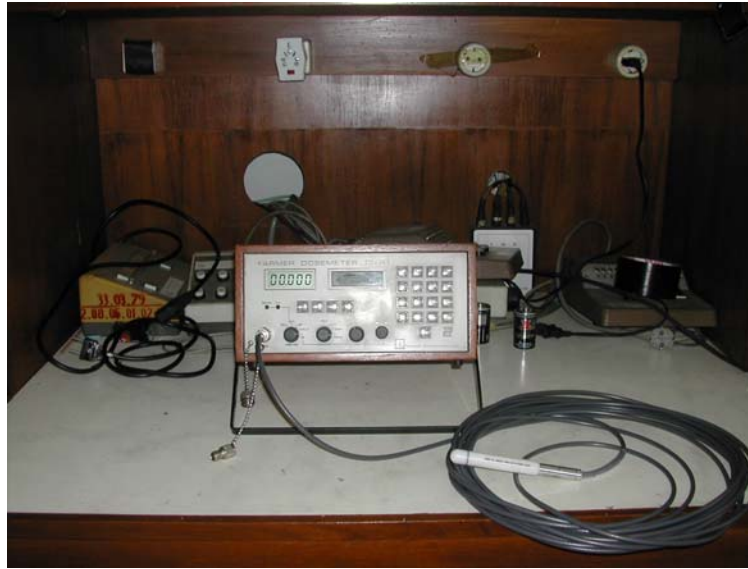
Gambar 1. Dosimeter Farmer tipe 2570 A dengan detektor 0,6 cc tipe 2581
