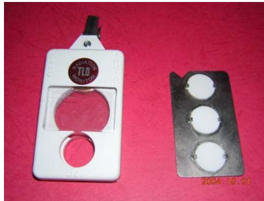
Gambar 1. TLD CaSO 4 :Dy buatan BARC India
