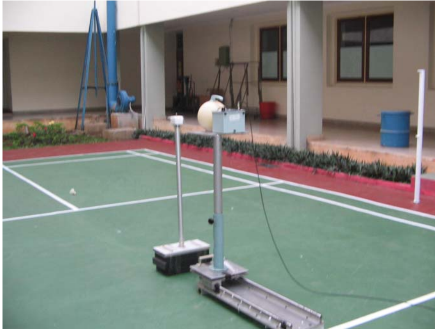
Gambar 1. Susunan peralatan pada pengukuran respon detektor NE MK 7 NRM di ruang tanpa atap berukuran 30 m x 15 m. Detektor dan sumber radiasi ^{252}\text{Cf} diletakkan pada ketinggian yang sama yaitu 120 cm dari lantai dengan jarak yang bervariasi mulai dari 50 cm s/d 120 cm.
