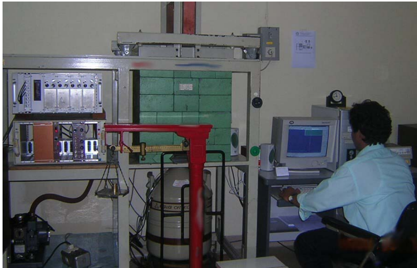
Gambar 2. Sistem spektrometer gamma yang dilengkapi dengan detektor HPGe
