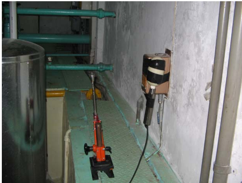
Gambar 3. Susunan peralatan pada kalibrasi alat ukur radiasi monitor area.
