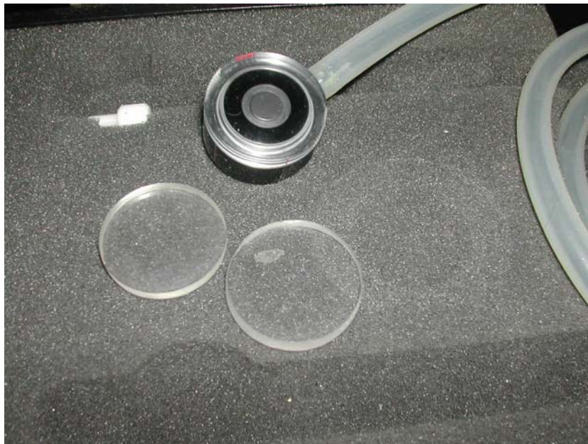
Gambar 1. Detektor ionisasi keping sejajar Markus tipe 23343 yang digunakan untuk pengukuran berkas elektron energi \leq 5 \text{ MeV}
