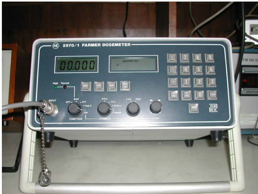
Gambar 2. Elektrometer Farmer yang digunakan sebagai alat baca detektor ionisasi keping sejajar Markus tipe 23343.
