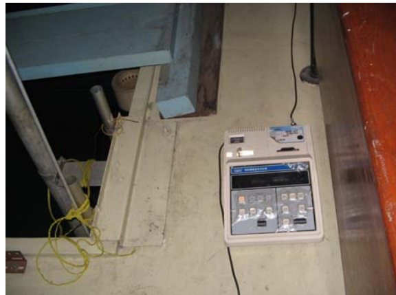
Gambar 1. Rangkaian alat ukur radiasi standar yang terdiri dari elektrometer Aloka dengan detektor kamar ionisasi.
