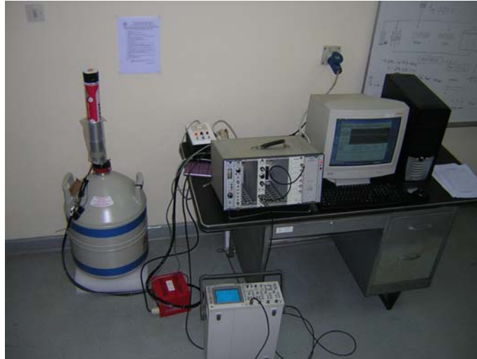
Gambar 1. Sistem Spektrometer Gamma dan Detektor HPGe Model GC1018
