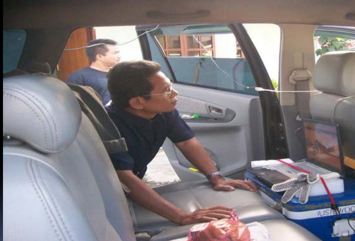
Setting system pengukuran laju dosis radiasi gamma dan GPS dalam kendaraan
