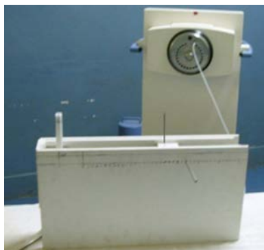
Gambar 1. Kalibrasi sumber brakiterapi Ir-192 di udara dengan menggunakan detektor ionisasi dan penyangganya [12] .
