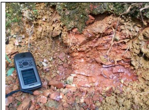
Gambar 5.1. Singkapan batupasir yang mengalami oksidasi tinggi.
