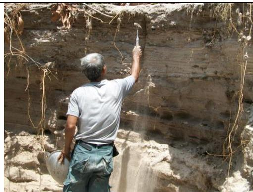
Gambar 15.1. Pengambilan sampel dengan *channel sampling* pada aluvial
