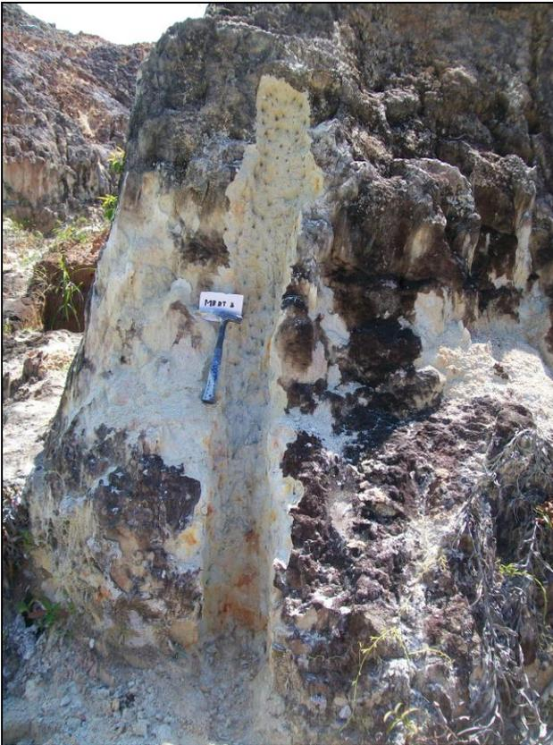
Gambar 2.1. Percontohan pada Granit Lapuk secara *Channel Sampling*
