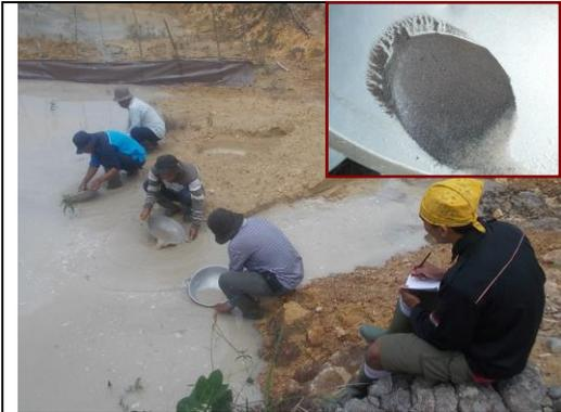
Gambar 15.3. Proses pendulangan untuk mendapatkan mineral berat
