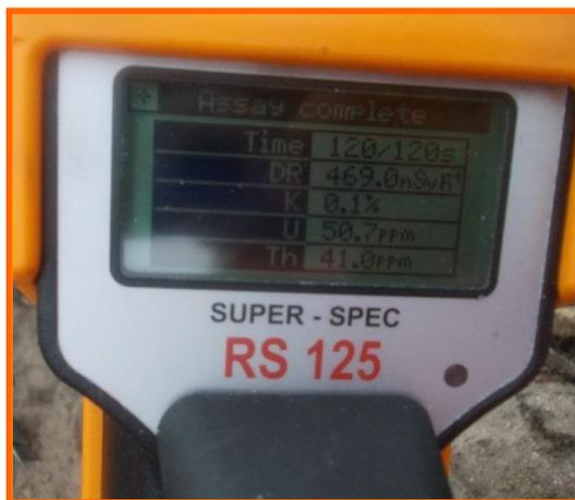
Gambar 22. Pasir zirkon hasil penambangan (Pengukuran U, Th, K dengan RS 125)
