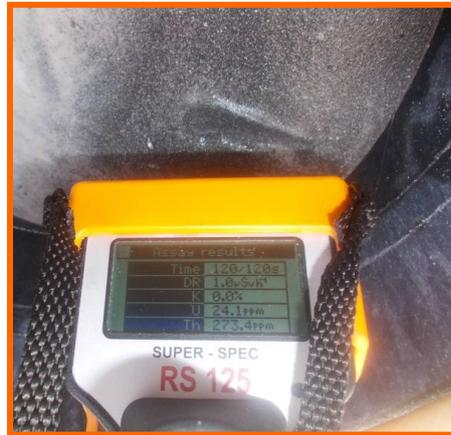
Gambar 21. Pasir timah hasil penambangan (Pengukuran U, Th, K dengan RS 125)
