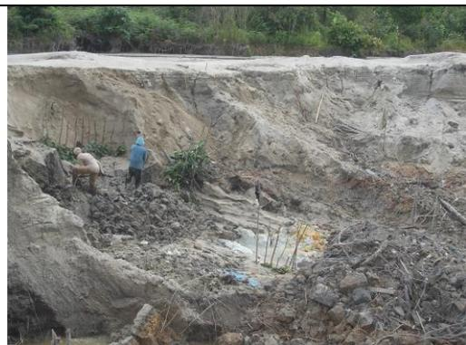
Gambar 11.4. endapan aluvial pada lokasi tambang timah dengan batuan dasar granit (Oc, 260)
