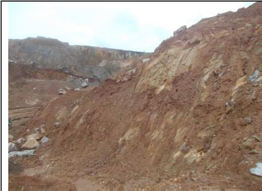
Gambar 6.3. Singkapan granit pada kupasan tambang timah primer (Oc. 244)
