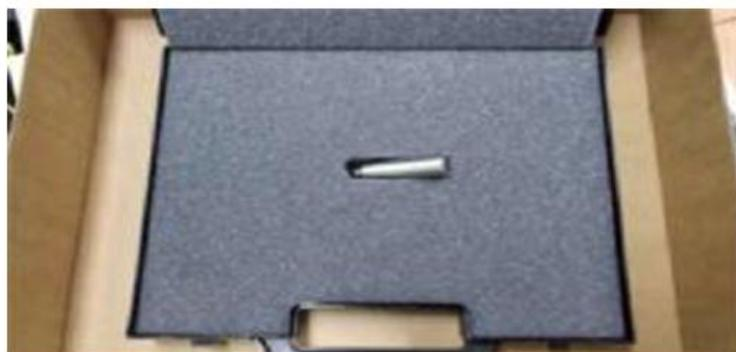
Gambar 7. *Probe* RTD 18-974 untuk pengujian *ultrasonic* terhadap PIN PWR
