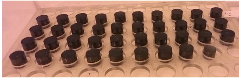
Gambar 1. Pelet mentah UO 2 diperkaya 2 %
