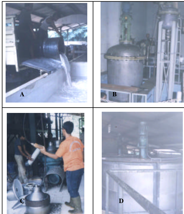
Gambar 2. Lateks kebun yang dipanen tanggal 23 & 27 Desember 2002 dari Perkebunan Jalupang PTPN VIII (A), divulkanisasi radiasi dengan sinar ^{60}\text{Co} di P3TIR BATAN Jakarta (B), lalu dipekatkan di Pabrik Lateks Pekat Jalupang (C), maka terjadilah lateks pekat pra-vulkanisasi radiasi yang langsung dikirim ke pabrik tensimeter PT.SIA Padalarang, tanggal 1 Januari 2003, dan pabrik kondom Banjaran PT. MRB Bandung tanggal 8 Januari 2003.
