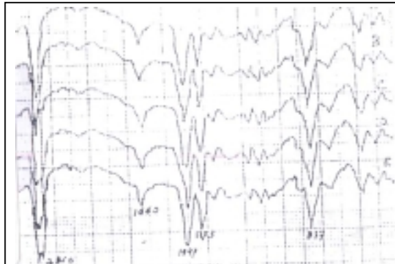
Gambar 2. Spektrum Infra Merah Karet Alam Hasil Vulkanisasi Rdiasi Dari Lateks Yang Berbeda Teknik Pekatannya.
