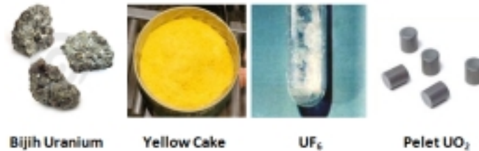
Gambar 2.15 – Proses fabrikasi bahan bakar nuklir
