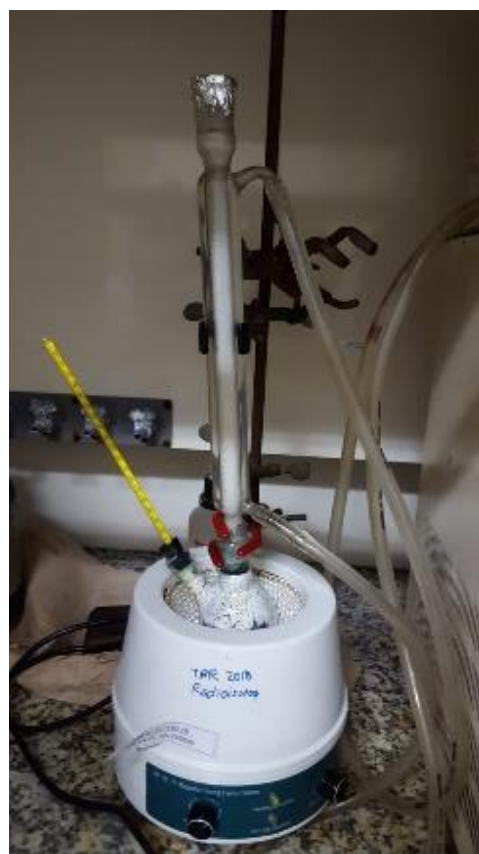
Sintesis Molibdenum Ftalosianin dengan Metode Refluks
