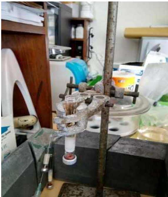
Kolom berisi Matriks Zirkonium Oksida untuk Generator Radioisotop ^{113}\text{In}
