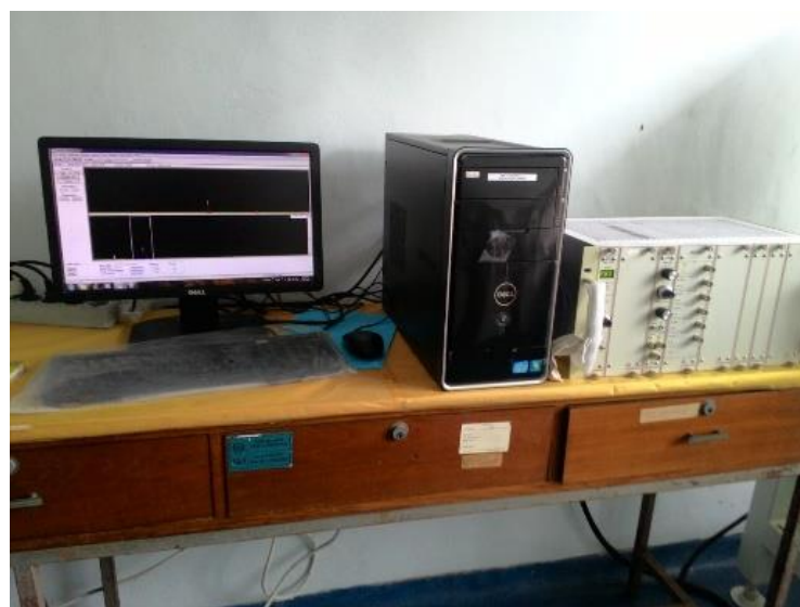
Penentuan Kemurnian Radionuklia In-113m dengan Pencacah Multi Saluran
