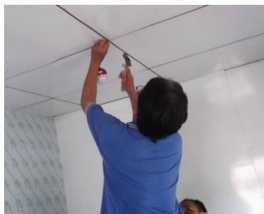
Gambar 3. Pemasangan monitor radon pasif di dalam rumah penduduk.
