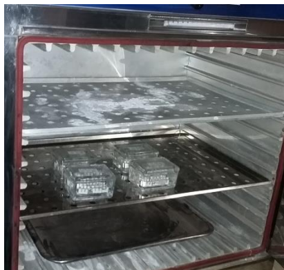
Gambar 4. Proses etsa detektor CR-39 di dalam Staining Jar.
