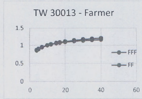
Gambar 12. Faktor keluaran berkas foton 6 MV FF dan FFF mulai dari lapangan 5cmx5cm sampai dengan 40cmx40cm yang diukur dengan detektor ionisasi volume 0,6 cc tipe TW 30013.
