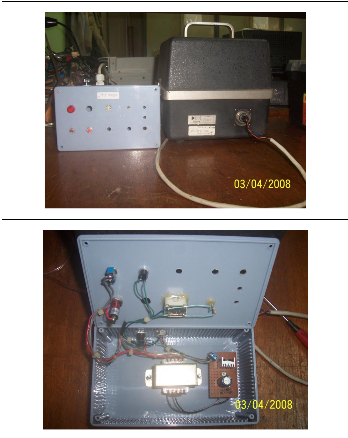
Gambar 5. Dokumentasi pembuatan perangkat uji transduser TS-3 trigger/switch
