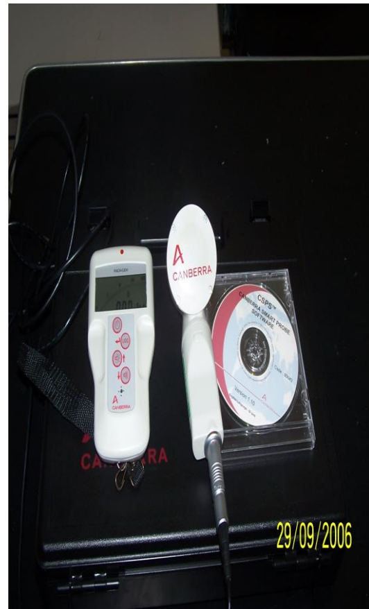
Gambar 2. Surveymeter kontaminasi Radiagem
