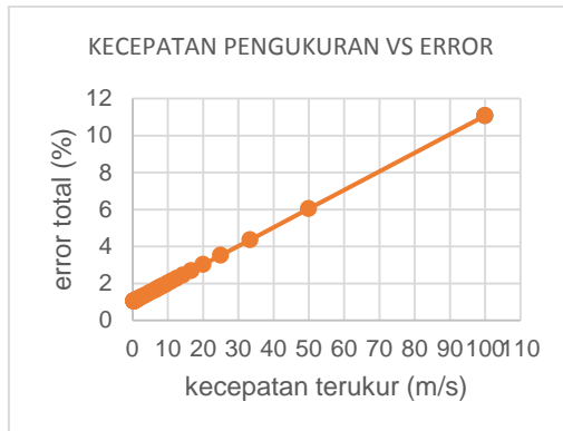
Gambar 8. Grafik perbandingan kecepatan terukur (m/s) vs Error Total (%)
