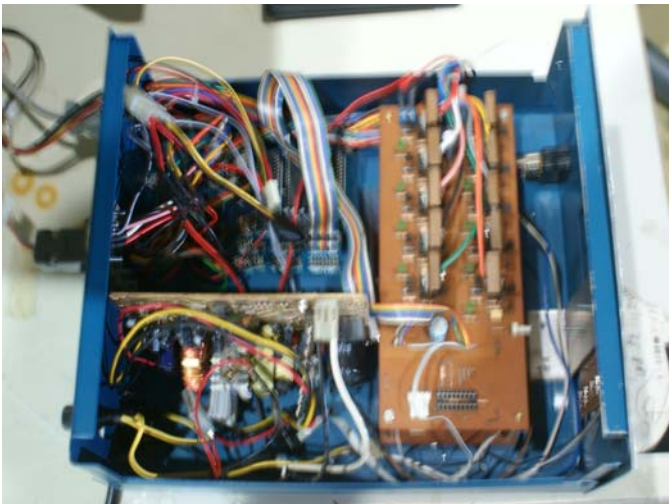
Gambar 5: Driver DT 51 untuk mengontrol pergerakan meja.
