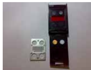
Gambar 1. TLD tipe 7776 untuk pemantauan dosis perorangan di PTNBR.
