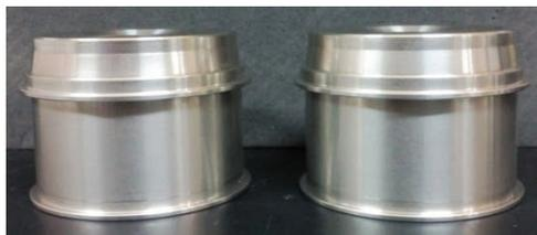
Gambar 5. Bagian luar *sample holder* yang terbuat dari *stainless steel*
