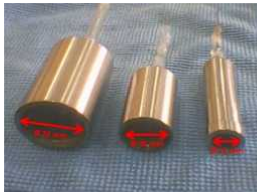
Gambar 3. Tabung detektor Geiger-Mueller tipe end window dengan diameter 11 mm, 16 mm dan 22 mm
