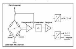
Gambar 7. Skema rangkaian pengolah sinyal pada MFM
