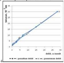
Gambar 10. Hubungan penunjukan debit pada MFM dengan tekanan pada ruang vakum sistem uji sumber ion
