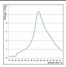
Gambar 9. Hubungan prosentase bukaan PSV dengan debit gas yang terukur pada MFM
